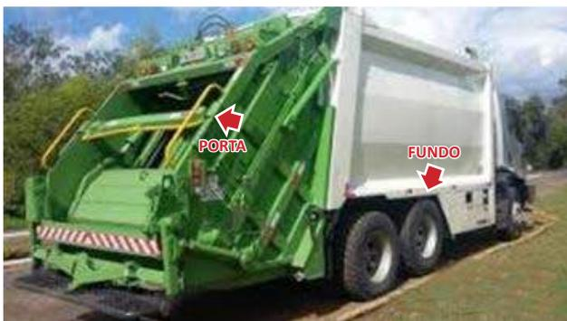
O vazamento de chorume ocorre devido à corrosão por pites no fundo da caixa de carga de caminhões coletores de lixo, o que resulta em furos nas chapas. Mesmo em
